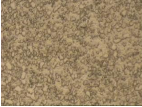
Şekil 7. X46Cr13 kalitesinde olan 03 no' lu döküme ait Ø 15 mm yuvarlak haddelenmiş mamulün ısı işlemi sonrasında gözlenen mikroyapısı (500x)
