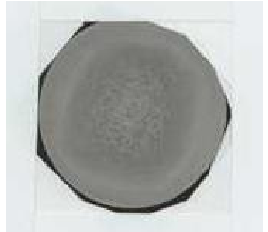
Şekil 2. 01 no' lu döküme ait \varnothing 32 mm yuvarlak hadde mamulünde makro dağlama
