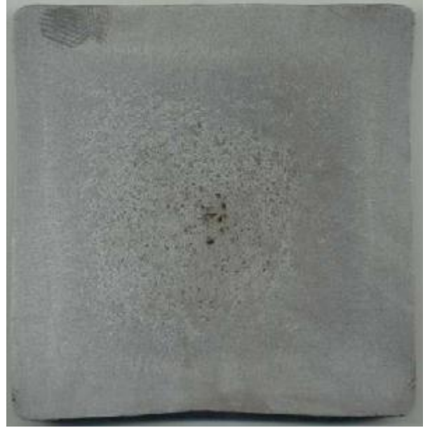
Şekil 1. 01 no' lu döküme ait 140x140 mm kütükte makro dağlama
